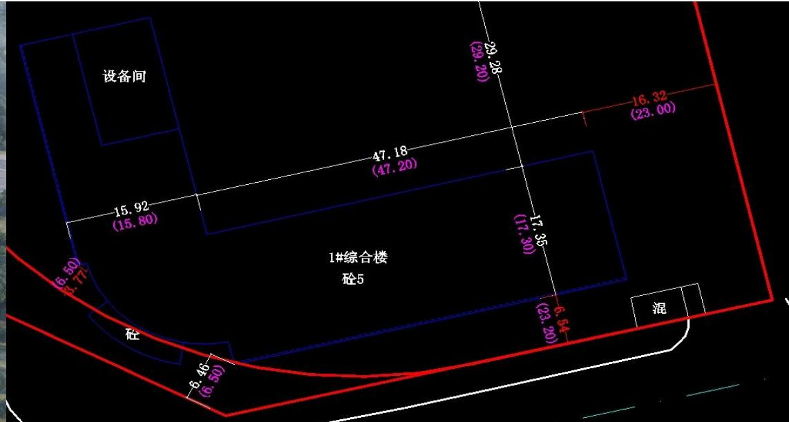
**公示说明：**陕西长枫天诚建筑科技有限公司建设的建筑支护设备生产基地及总部结算中心项目1#综合楼整体向南偏移16.66米（审批退南侧用地红线23.20米，实际退用地红线6.54米）；1#综合楼整体向东偏移6.68米（审批退东侧二期分割线23.00米，实际退东侧二期分割线16.32米）。
