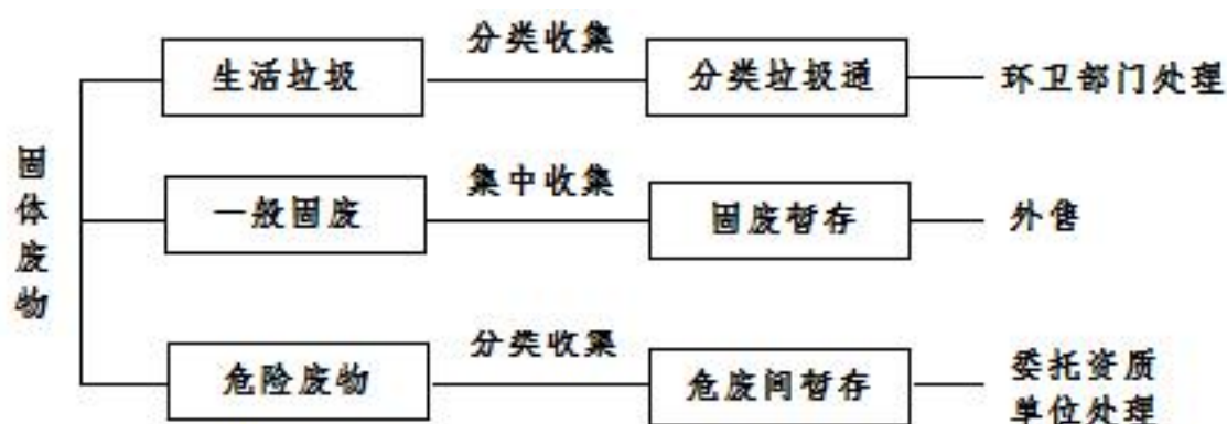
图3 固体废物处理流程示意图
