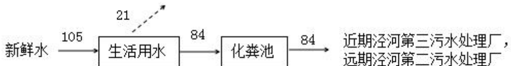
图 1 项目水平衡图 单位： \text{m}^3/\text{d}
