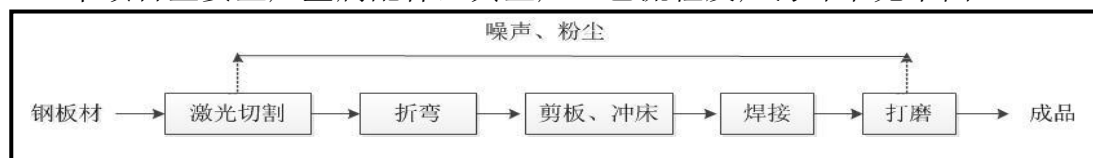
图 1 本项目生产工艺流程及产污环节图
